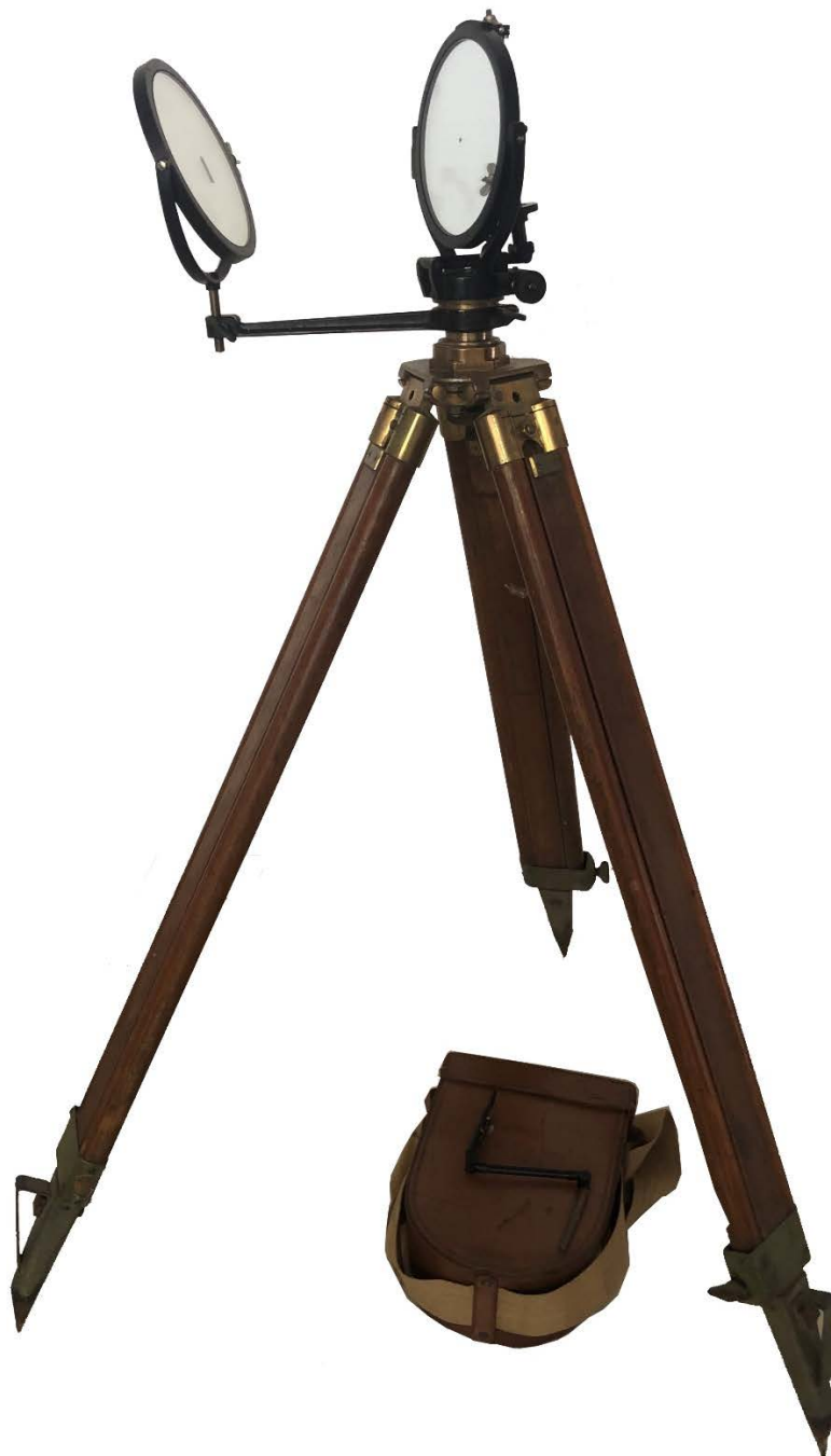
הליוגרף 5 אינטש דגם 5 על חצובה מקור: אוסף העמותה להנצחת חללי חיל הקשר והתקשוב
