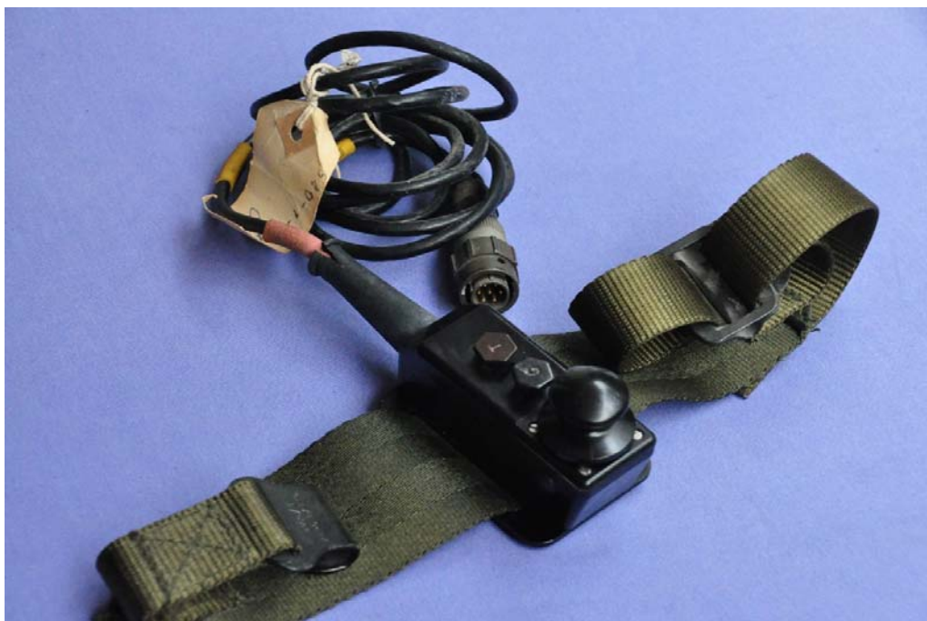
מפתח בריטי זעיר של משפחת Clansman, שנועד לשימוש עם PRC-320
