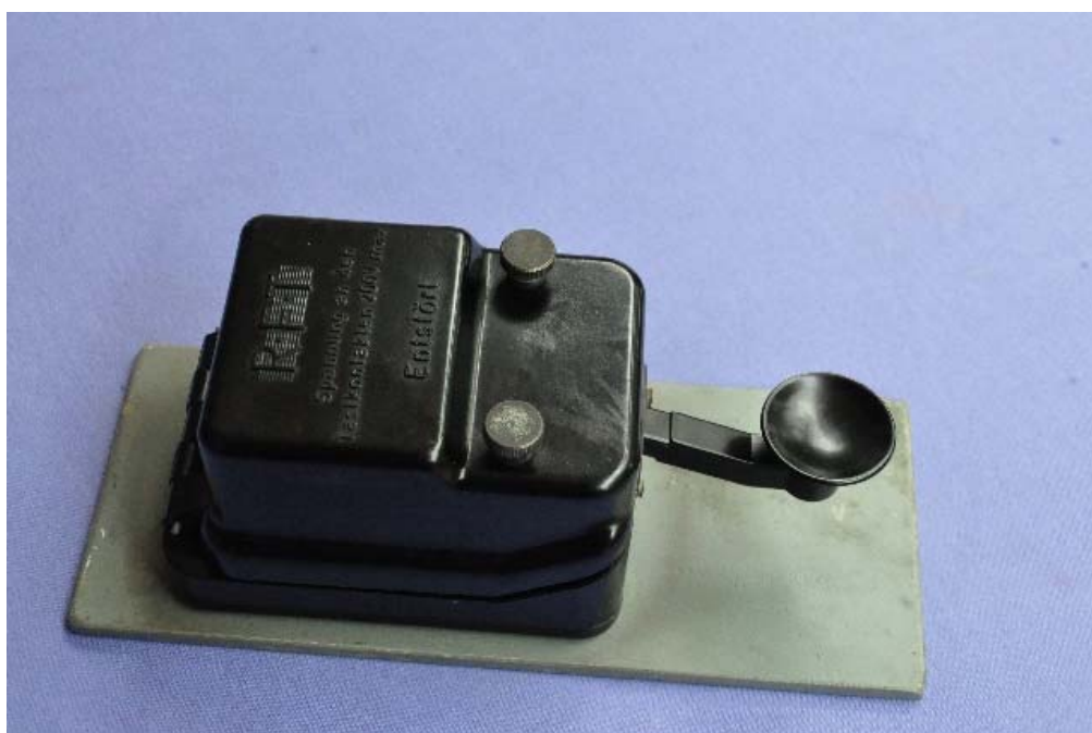
מפתח MT 50, תוצרת RFT, מזרח גרמניה גרסה מזרח גרמנית של מפתח דגם Junker
