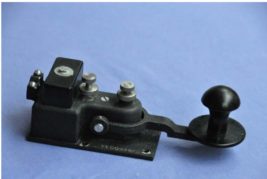
מפתח כולא ניצוצות (Flameproof) של הצי האמריקאי, דגם 26003, מהתקופה בין שתי מלחמות העולם מפתח זה נועד גם להפעלת פנסים, לאיתות ראייה בשעות הלילה.
