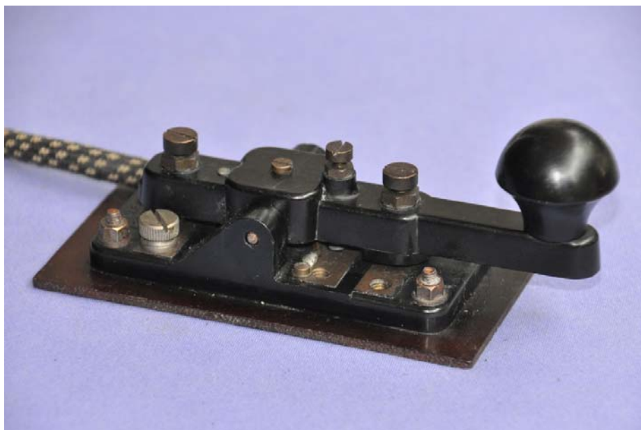
גרסה "מתקדמת", MK III, של המפתח הבריטי WT-8 ממלחמת העולם השנייה
