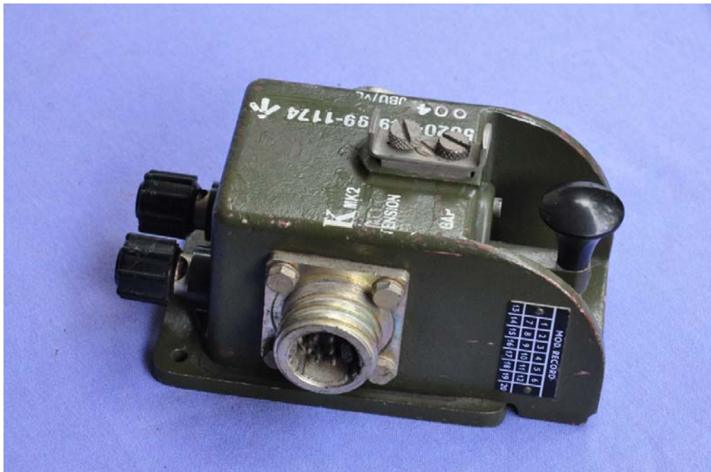
מפתח מורס צבאי בריטי KMK-2, משפחת Lakspur, תקופת המלחמה הקרה (1945 עד 1975)
