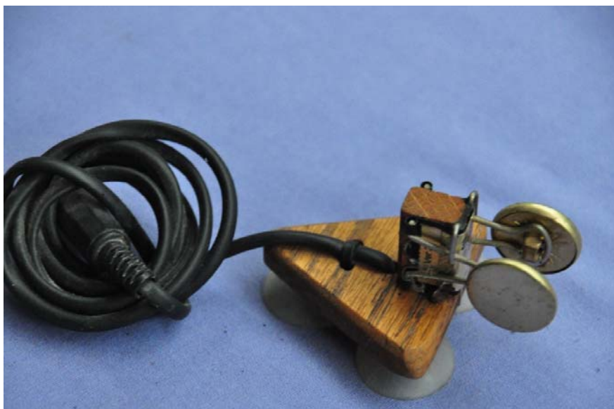
מפתח זעיר עם שתי דוושות לשימוש עם התקן מפתוח אלקטרוני "יאמבי" דגם Bulldog, תוצרת K9LU בארה"ב, שנות ה-2000
