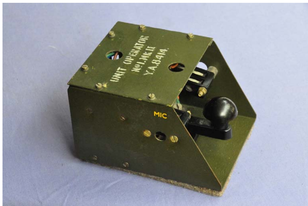
גרסה נוספת, MK II, של מפתח המורס הבריטי WT-8 ממלחמת העולם השנייה, בקופסת הפעלה מרחוק של מכשיר רדיו
