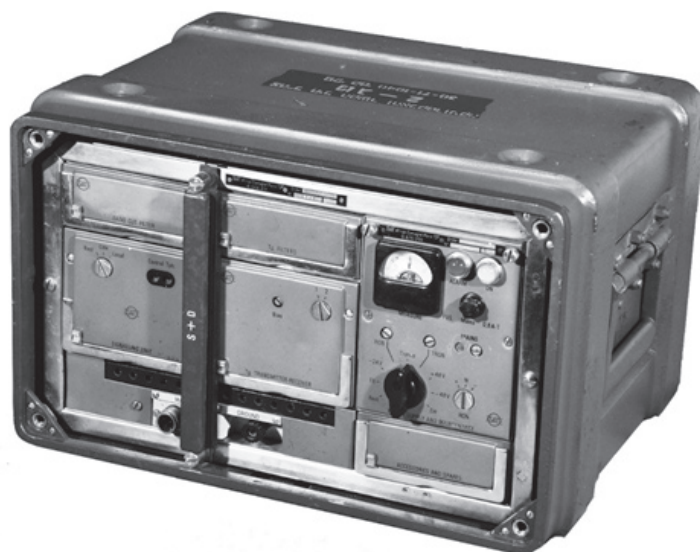
מכשיר להעברת דיבור וטלגרפיה על אותו קו (S+DX), טג-2 מקור: אוסף העמותה להנצחת חילי הקשר והתקשוב
