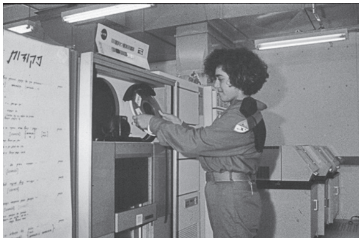
הורדת סרט מגנטי לגיבוי, בקרת מערכת (במ"ע) ב"אבן יקרה" מקור: אוסף העמותה להנצחת חילי חיל הקשר והתקשוב
