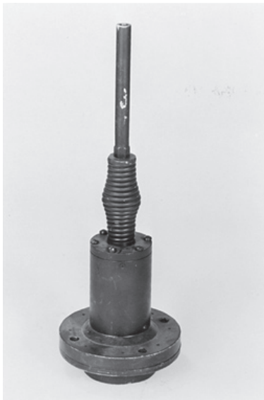
בסיס אנטנה אנטנה רחבת סרט ללא כבל בקרה, עליה מותקנות חוליות אנטנה מקור: אוסף העמותה להנצחת חללי חיל הקשר והתקשוב
