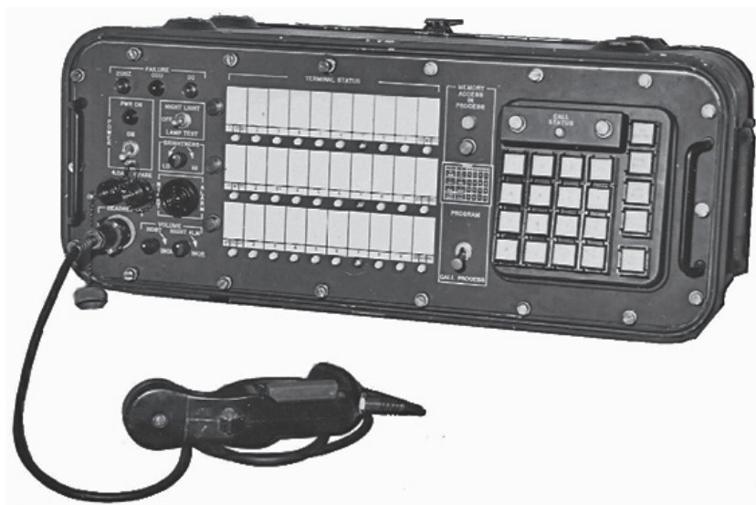
מרכזיית שדה אוטומטית מרכז-3614 מקור: אוסף העמותה להנצחת חיל הקשר והתקשוב
