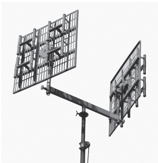
שתי אנטנות אנ-1202, בקיטוב אנכי, על זרוע בראש תורן טלסקופי אנ-910 מקור: אוסף העמותה להנצחת חילי חיל הקשר והתקשוב
