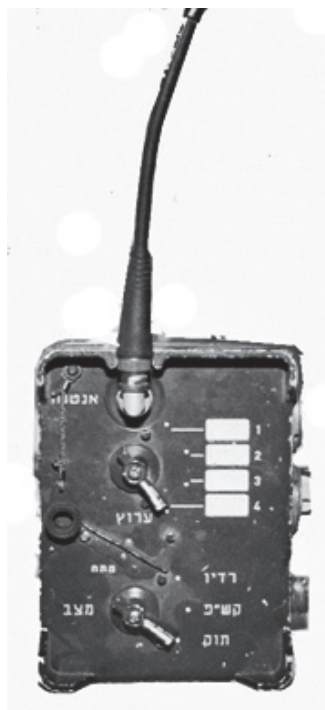
קש"פ אלחוטי, לשילוב מכשיר קשר נישא בקשר פנים של רק"ם. הקופסה איפשרה ללוחם חי"ר סמוך לרק"ם לשוחח בקש"פ של הרק"ם מקור: אוסף העמותה להנצחת חללי חיל הקשר והתקשוב
