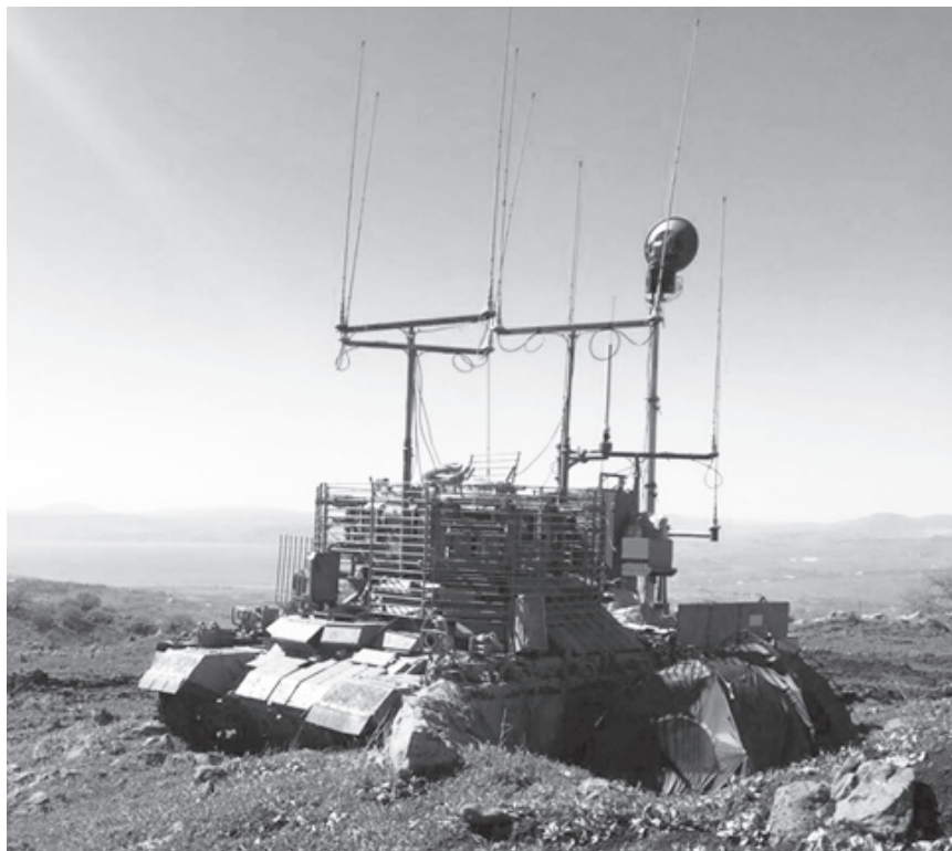
צומת "כבד": תק"ש (מוגן, במיגון "כלוב"), על נגמ"ש ממוגן גחון (נגמחור"ן), בפריסה ברמת הגולן, 2017. באדיבות דובר צה"ל ואתר אגף התקשוב
