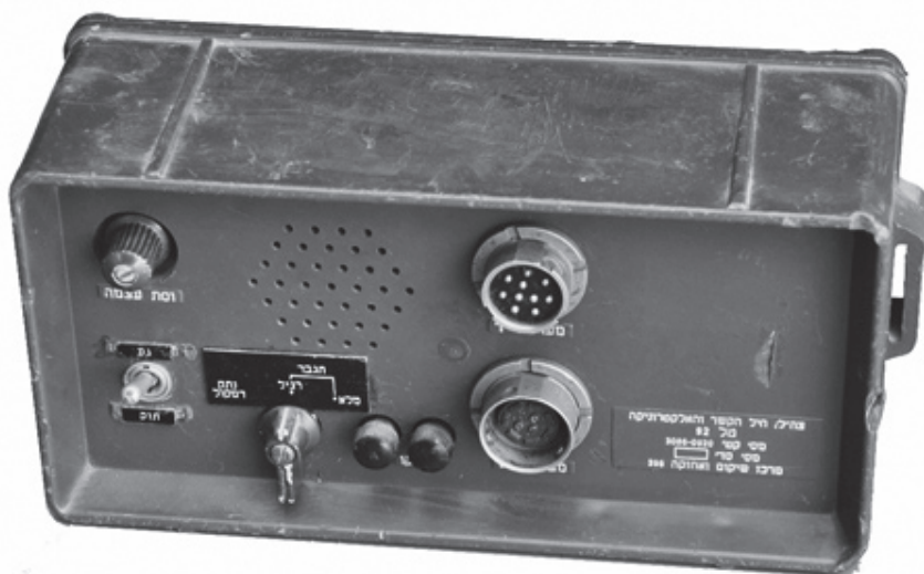
מגבר שמע טל-92, מגבר שמע עם רמקול ששימש להשמעת רשתות רדיו בחמ"לים מקור: אוסף העמותה להנצחת חילי חיל הקשר והתקשוב
