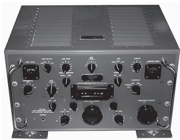
מקלט ת"ג מח-390, בשימוש יחידת לוחמה אלקטרונית מקור: אוסף העמותה להנצחת חיל הקשר והתקשוב
