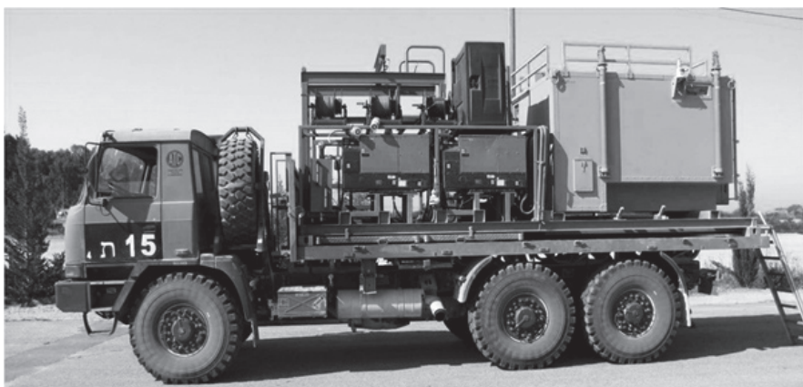
תק"ש תקשוב, תקש-184, התק"ש הממוזג מותקן על משאית "טטרה", יחד עם שלושה גנרטורים שמונה קו"א ותופי מתח. מקור: אוסף העמותה להנצחת חיל הקשר והתקשוב
