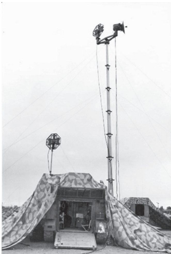
תורן פניאומטי על נגמ"ש רד"ט מקור: אוסף העמותה להנצחת חיל הקשר והתקשוב
