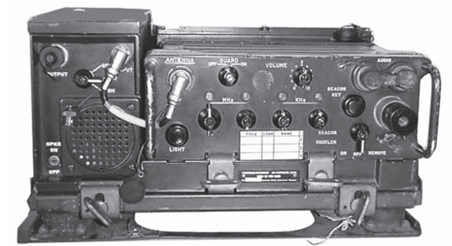
מכשיר קשר קרקע-אוויר מוסע מק-240 מקור: אוסף העמותה להנצחת חללי חיל הקשר והתקשוב
