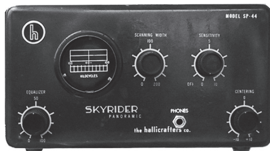
מתאם פנורמי למקלט ת"ג מח-44, בשימוש יחידת לוחמה אלקטרונית מקור: אוסף העמותה להנצחת חיל הקשר והתקשוב
