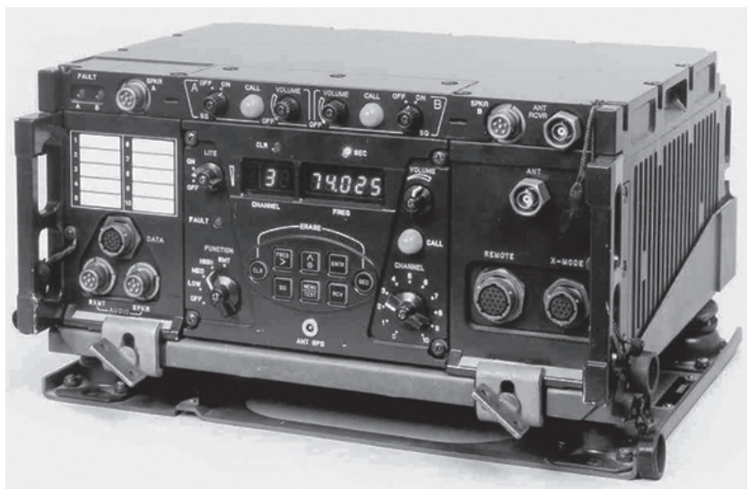
תצורה של מקמ"ש תג"ם ושני מקלטי עזר מקור: אוסף העמותה להנצחת חילי חיל הקשר והתקשוב
