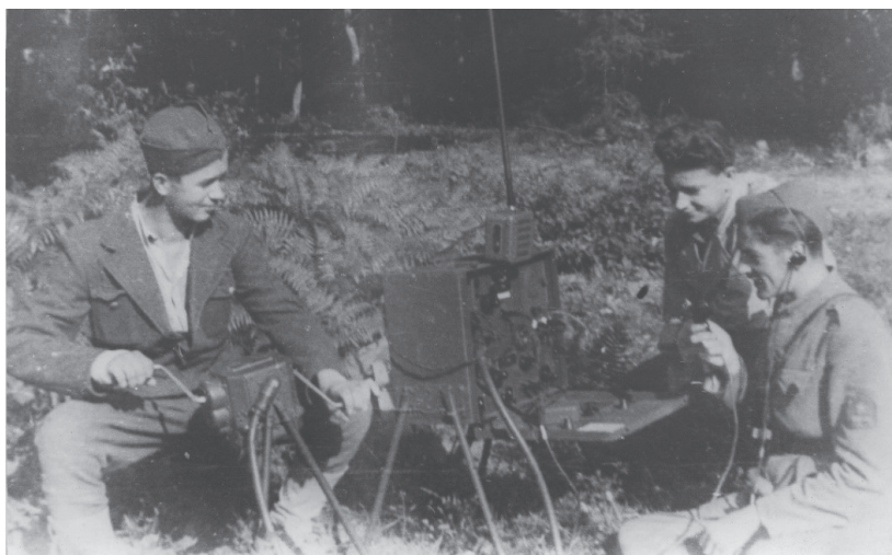
צנחנים בצבא הבריטי מפעילים מק-284 חייל אחד מפעיל את המכשיר וחייל שני מסובב את ידית הגנרטור. באדיבות ארכיון ה"הגנה", 10681
