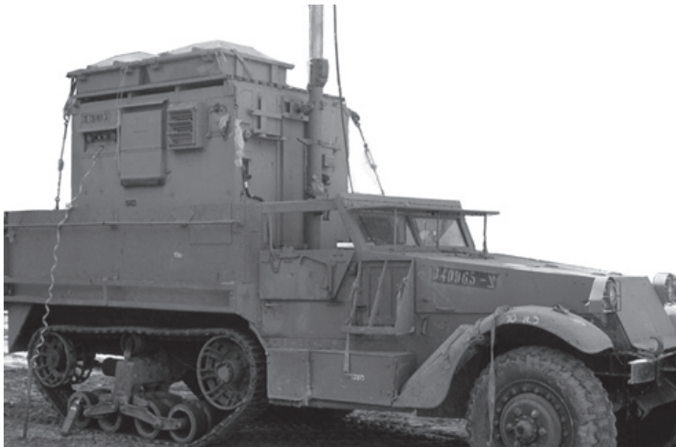
תק"ש רד"ט - תקש-324 ארגזי הפיברגלס על הגג שימשו לאחסון אנטנות אנ-1200 / אנ-1202 מקור: אוסף העמותה להנצחת חיל הקשר והתקשוב
