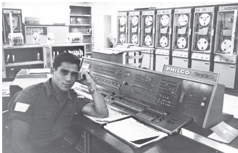
הפעלת מחשב הפילקו הראשון פילקו 211, 1962 מפעיל ליד שולחן הבקרה, מאחוריו מכונת כתיבה חשמלית Flexo לתיעוד ההרצות. מימין כונני סרטים מגנטיים ששימשו כאמצעי קלט/פלט וכשטחי עבודה למיין נתונים והכנת דו"חות להדפסה. באדיבות ארכיון ממר"ם
