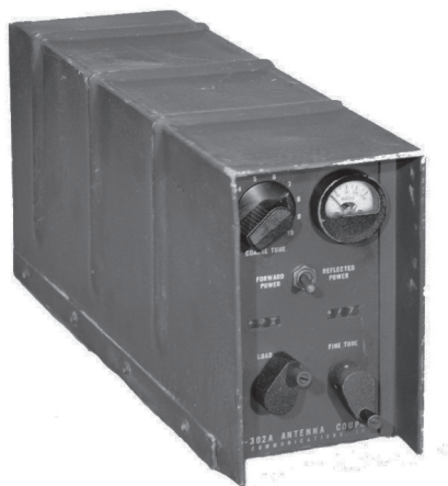
מח-1302, מתאם אנטנה ידני של מק-58 מקור: אוסף העמותה להנצחת חיל הקשר והתקשוב
