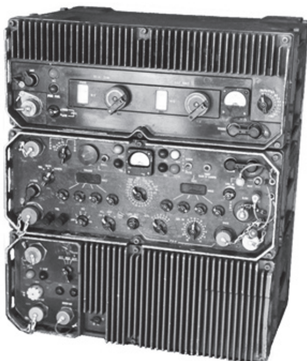
מק-201, מקמ"ש רד"ט בתחום התא"ג מקור: אוסף העמותה להנצחת חללי חיל הקשר והתקשוב
