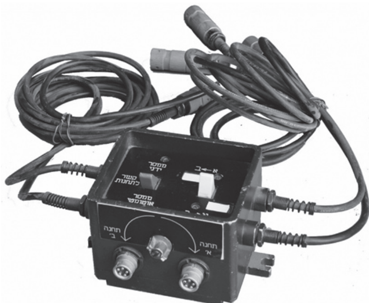
קפ-1225, קופסת ממסר למכשירי מק-25/מק-77 מקור: אוסף העמותה להנצחת חילי חיל הקשר והתקשוב
