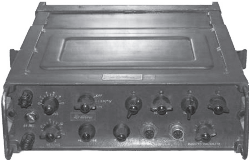
מקמ"ש חד-פס נישא מק-74 מקור: אוסף העמותה להנצחת חיל הקשר והתקשוב
