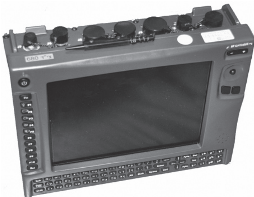
מסך מחשב טקטי דור ב' צג מוקשח המשמש ליישומי שו"ב ברק"ם מקור: אוסף העמותה להנצחת חללי חיל הקשר והתקשוב
