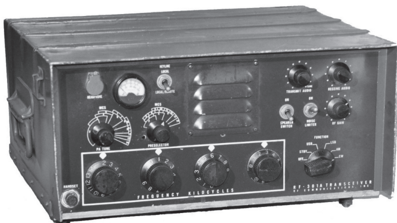
מח-1301, מקמ"ש של מק-58 מקור: אוסף העמותה להנצחת חיל הקשר והתקשוב
