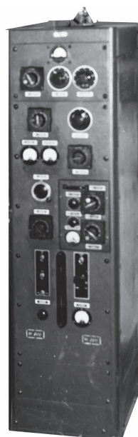
משדר ת"ג נייח מק-81 מקור: אוסף העמותה להנצחת חילי חיל הקשר והתקשוב
