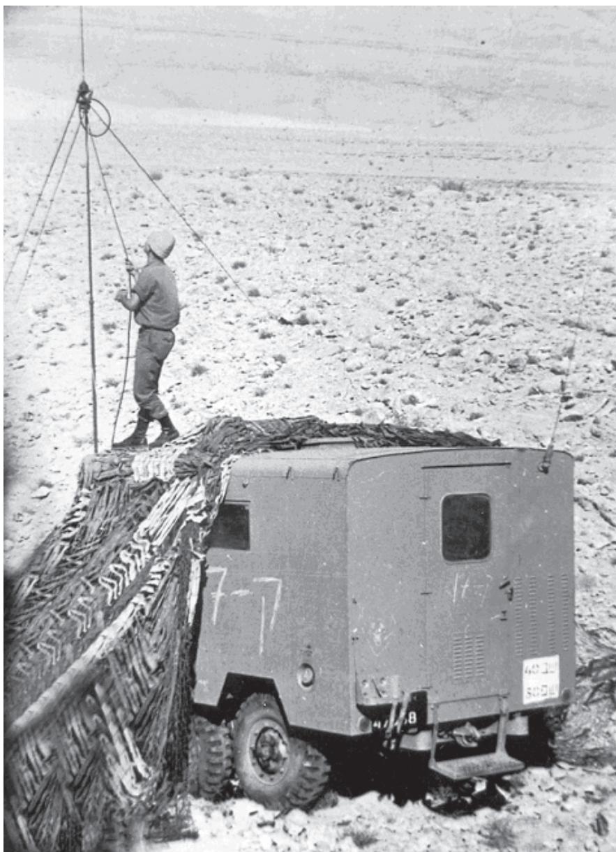
הקמת אנטנה אנ-1292 ("ספוטניק") על רקש-120 מקור: אוסף העמותה להנצחת חילי חיל הקשר והתקשוב
