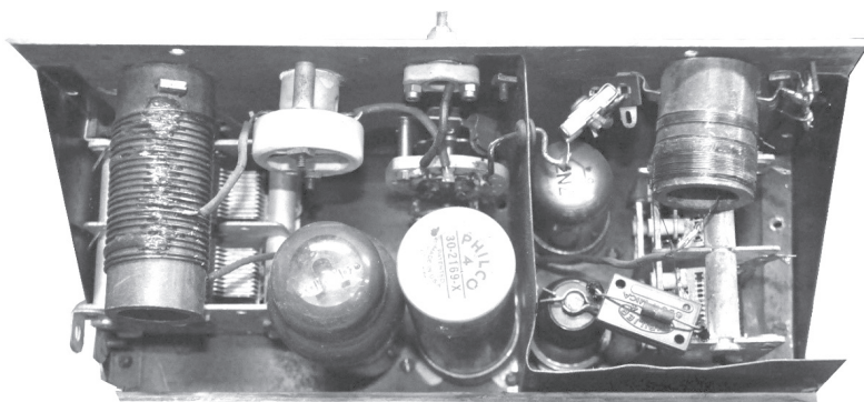
תוכו של מקמ"ש מזוודה מימין המקלט, המבוסס על שתי שפופרות: 6SK7 ו-6N7. משמאל המשדר, המבוסס על שפופרת 6V6 בודדת מקור: אוסף העמותה להנצחת חילי חיל הקשר והתקשוב
