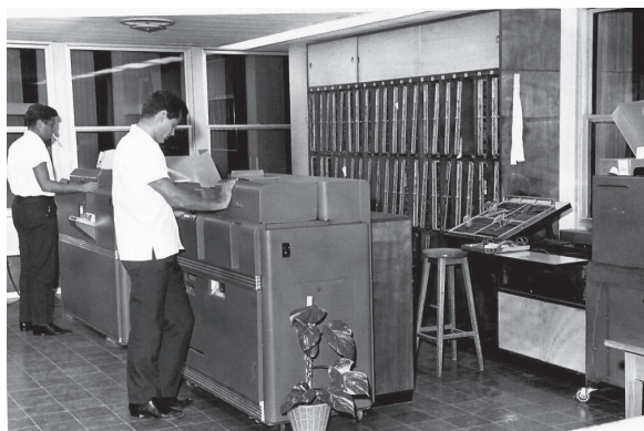
תפעול מכונות בממ"ס, שנות החמישים ברקע: לוחות חיווט (עליהם בוצע ה"תכנות" למיון/ליווח) באדיבות ארכיון ממר"ם
