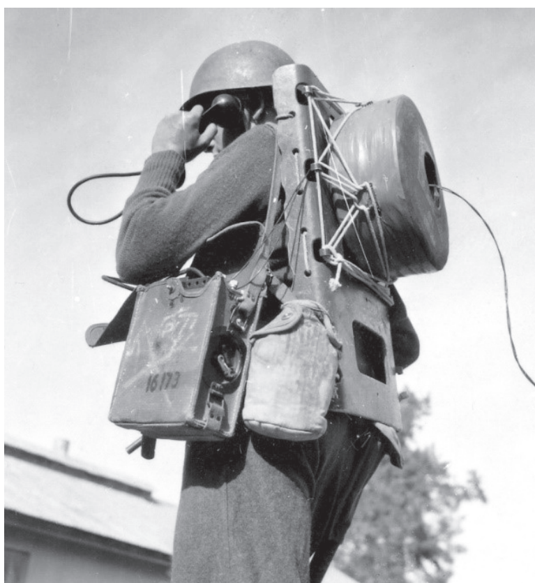
סלילת כבל שדה ח-10 ממפזר כבלים מפזר הכבלים (Wire Dispenser MX-306) כלל 800 מ' כבל ח-10 במעטה בד, שנועד לנשיאה על גב חייל בעזרת מנשא חי"ר. בעזרת טלפון שדה טל-8 ניתן היה לשוחח תוך כדי הפריסה. מקור: אוסף העמותה להנצחת חילי חיל הקשר והתקשוב
