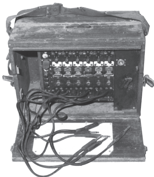
מרכזיית שדה לשישה מנויים מרכ-71 מקור: אוסף העמותה להנצחת חיל הקשר והתקשוב
