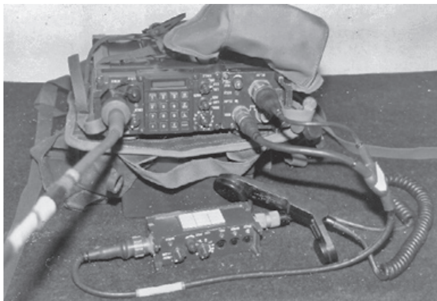
מכשיר קשר תג"ם ספרתי חדיש, עם קופסת פיקוד מקור: אוסף העמותה להנצחת חללי חיל הקשר והתקשוב
