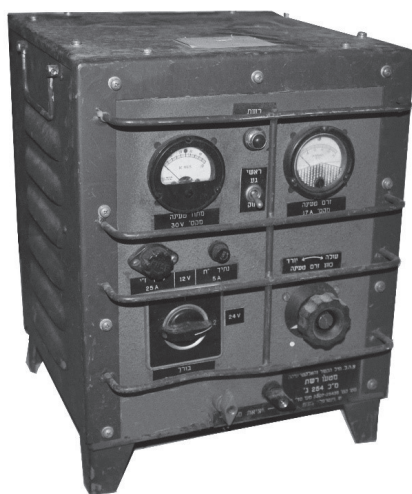
מטען רשת מכ-254 ג'. מטען רשת חד-פזי למערכות ז"י של 12 או 24 וולט, בזרם עד 17 אמפר. מקור: אוסף העמותה להנצחת חילי חיל הקשר והתקשוב
