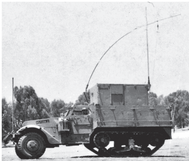
תקש-126 על זחל"ם – עם אנטנת ת"ג (מלפנים) ואנטנת תג"ם (מאחור) מקור: אוסף העמותה להנצחת חילי חיל הקשר והתקשוב
