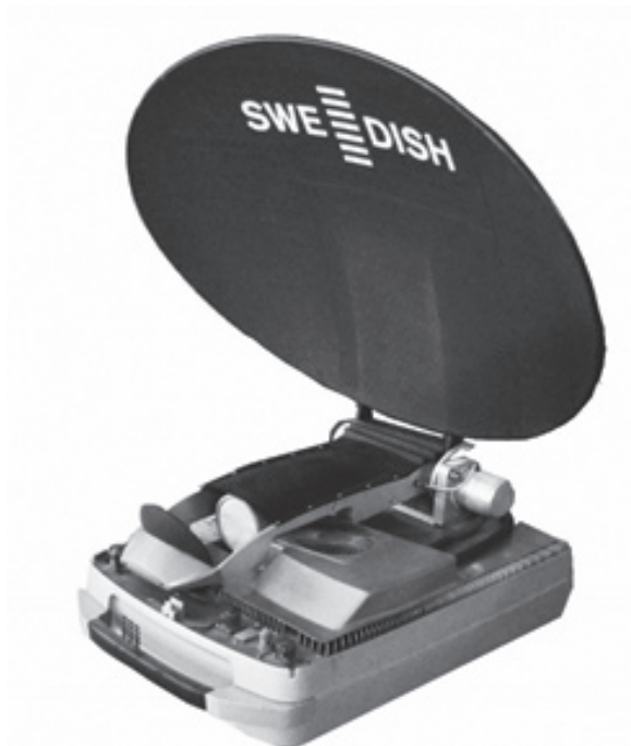
מסוף לווייני נישא קומפקטי, שהיה בשימוש בשנים 2007 עד 2012 מקור: אוסף העמותה להנצחת חילי הקשר והתקשוב
