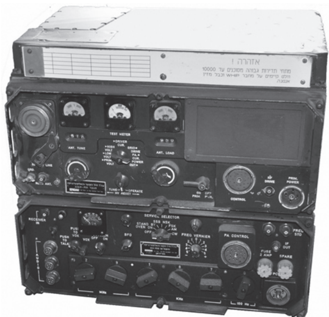
מק"מ"ש חד-פס מק-106 (מק"מ"ש מח-834 ומעליו מגבר הספק ומתאם אנטנה מח-3349) מקור: אוסף העמותה להנצחת חילי חיל הקשר והתקשוב
