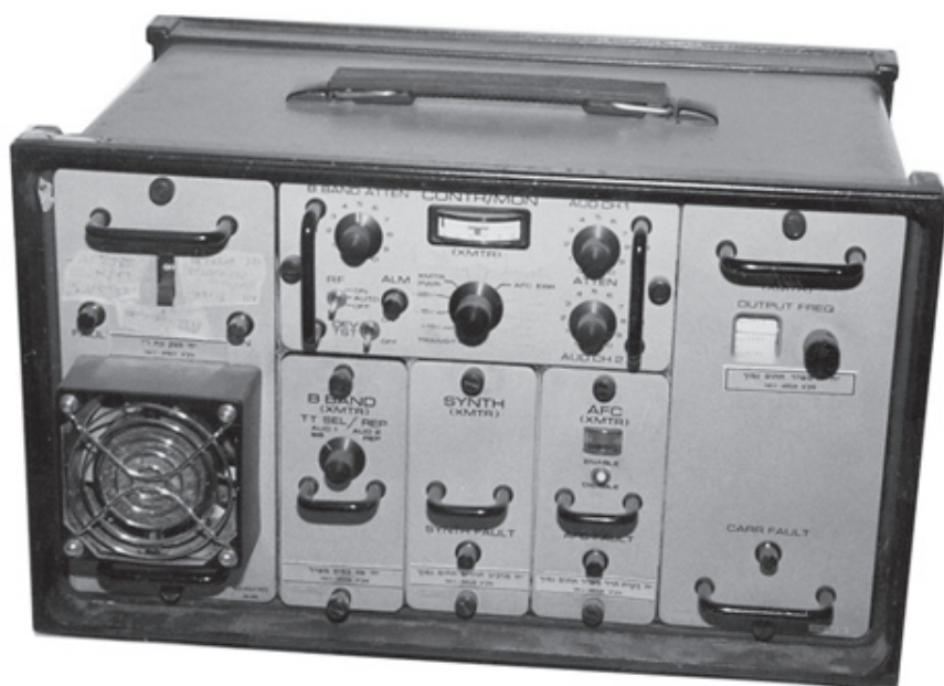
מקמ"ש מיקרוגל לתמסורת חוזי חיבורי הכבלים השונים נעשים בלוח במילואה האחורית. מקור: אוסף העמותה להנצחת חללי חיל הקשר והתקשוב
