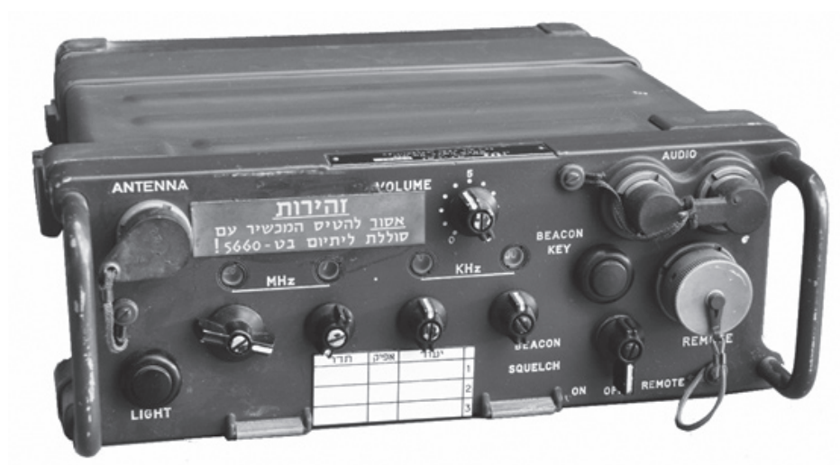
מח-6241, המקמ"ש בערכת מק-660 מקור: אוסף העמותה להנצחת חללי חיל הקשר והתקשוב
