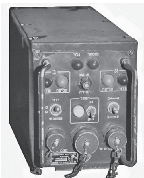
קופסת ממסר מתקדמת (ספרתית) בעידן ה-VRC מקור: אוסף העמותה להנצחת חללי חיל הקשר והתקשוב
