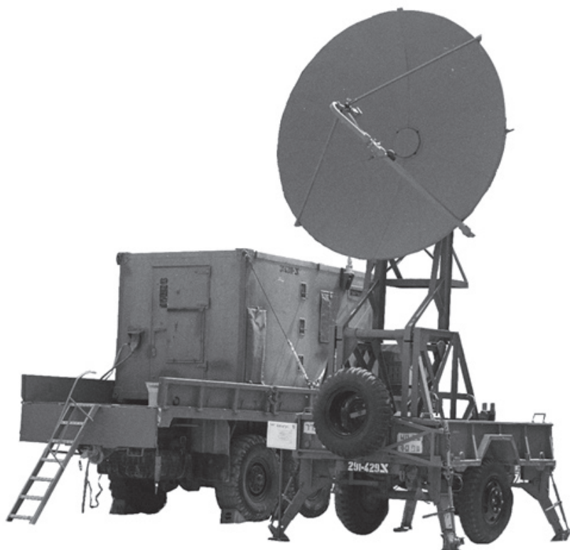
טרופו ספרתי מתקדם: תקש-358 ואנטנה על גרור, רקש-635 מקור: אוסף העמותה להנצחת חיל הקשר והתקשוב
