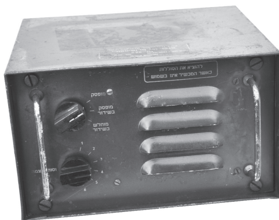
מגבר שמע טל-90, מגבר שמע עם רמקול שימש להשמעת רשתות רדיו מקור: אוסף העמותה להנצחת חילי חיל הקשר והתקשוב
