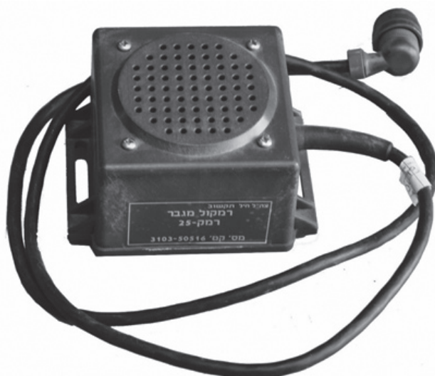
רמקול קל משקל עם מגבר שמע למק-25/מק-77, רמק-25 מקור: אוסף העמותה להנצחת חיל הקשר והתקשוב
