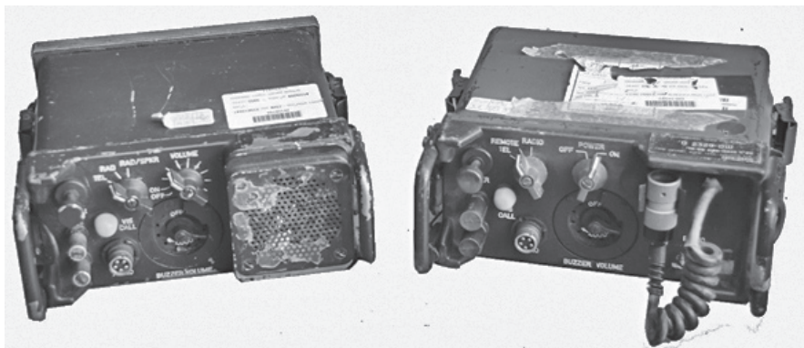
שלט רחוק צלילי, יח' קרובה (מימין), יח' רחוקה (משמאל) מקור: אוסף העמותה להנצחת חללי חיל הקשר והתקשוב
