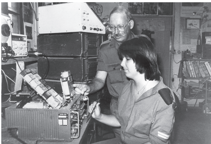
אימת הטכנאים: רס"ב גרינברג בוחן שלב מקצועי בתיקון תקלות במקמ"ש אוטומטי מח-246 מקור: אוסף העמותה להנצחת חללי חיל הקשר והתקשוב
