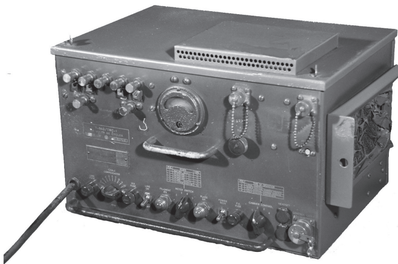
מח-2, המשדר במערכת רד"ט מק-1 מקור: אוסף העמותה להנצחת חיל הקשר והתקשוב
