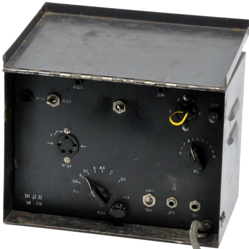
משדר מק-18: מכשיר מוכן לפעולה, עם מכסה קדמי מורם
