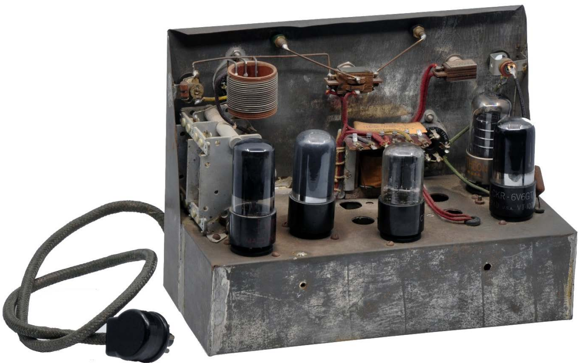
משדר מק-18: גב מכשיר פתוח השפופרות, מימין לשמאל: 6V6, 6V6, 1635, 6V6, 6SK7
