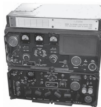
מק"ש חד"פס מק-106 (מק"ש מז-834 ומעליו מגבר הספק ומתאם אנטנה מז-3349) מקור: אוסף העמותה להנצחת חיל הקשר והתקשוב
